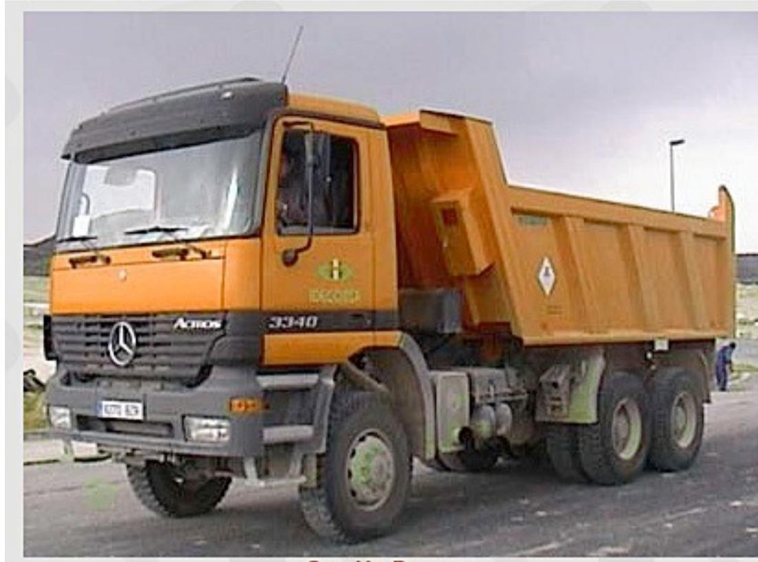
Un camión tipo dumper, con una bañera para transportar tierra, de tipo medio, tiene una capacidad de carga de  $15\text{m}^3$ , luego los residuos ocuparían ...
